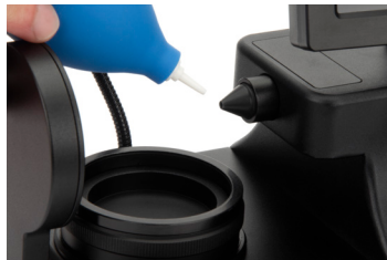
Limpieza de la cámara
